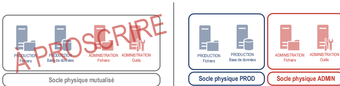
FIGURE 3.1 – Cloisonnement des socles physiques de virtualisation pour des serveurs
